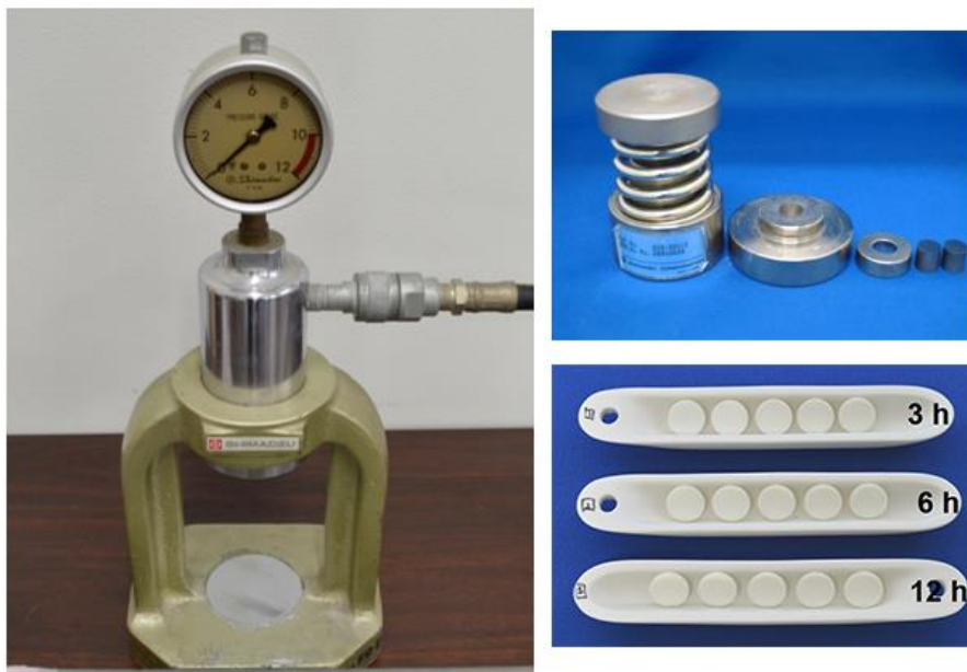
شکل ۱: تصویر قالب و پرس مورد استفاده برای پرس پودر زیرکونیا و نمونه‌های زینتر شده در سه زمان مختلف
