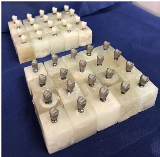
شکل ۱: کوپینگ‌های ساخته شده از جنس زیرکونیا و آلیاژ سینترون
