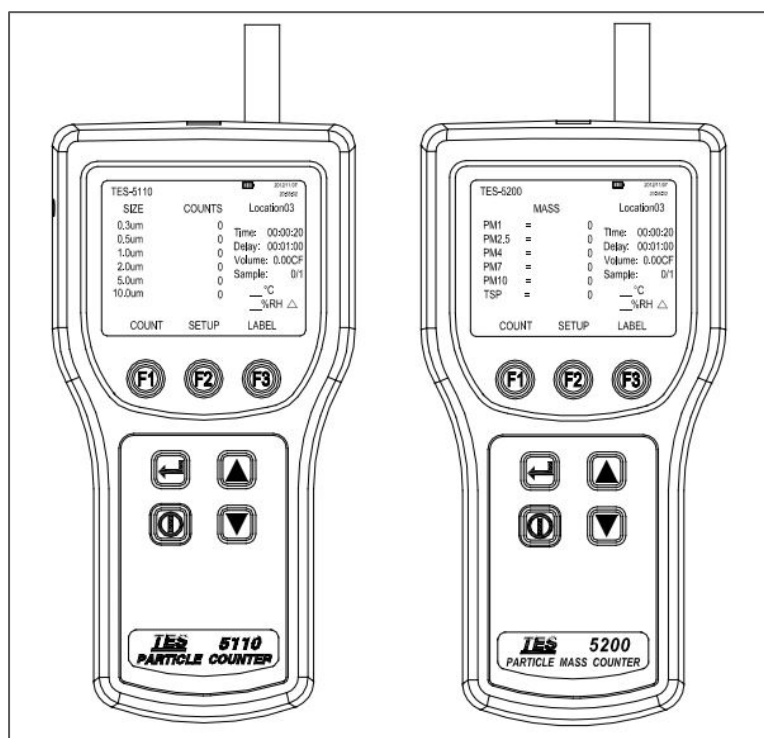
شکل ۱. نمایشی از دستگاه شمارنده ذرات معلق Particle Mass Counter مدل Tes 5200 ساخت کشور تایوان
