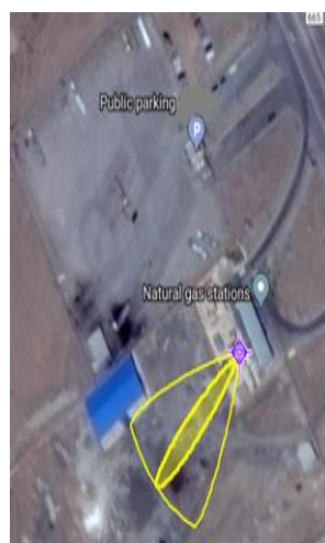
شکل ۲: محدوده ابر بخار سمی ناشی از شکاف ۲۰ سانتی‌متر
