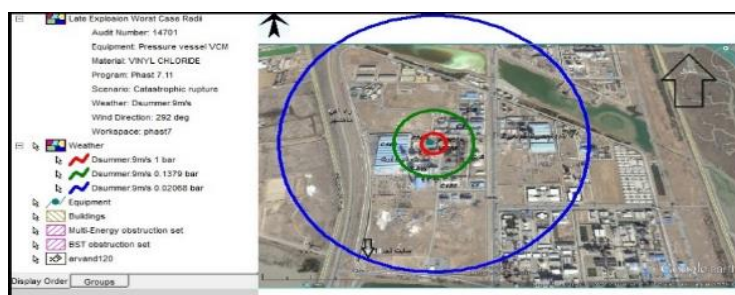
شکل ۳: موج فشار انفجار ابر بخار برحسب بار ناشی از پارگی کامل مخزن
